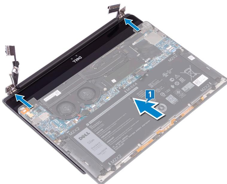
2. À l'aide des embouts d'alignement, appuyez sur les charnières de l'écran sur l'ensemble repose-poignets et alignez ses trous de vis avec ceux de l'ensemble repose-poignets.
